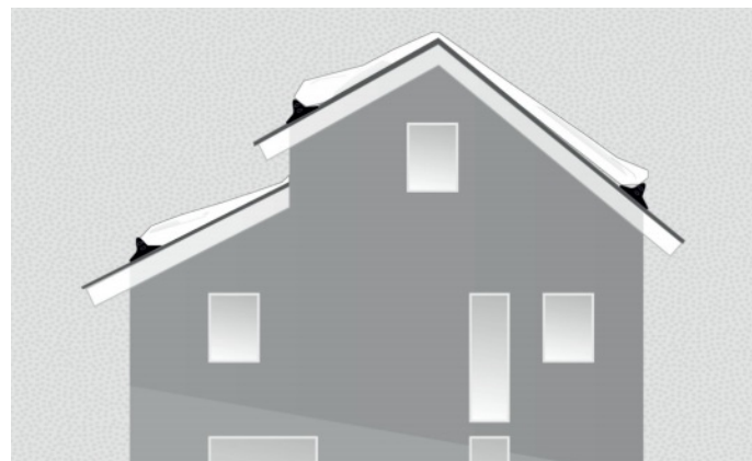
Снегозадержатели устанавливают на каждый скат многоуровневых крыш
