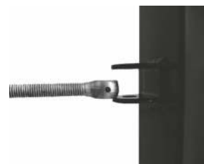
Откидной болт петли
